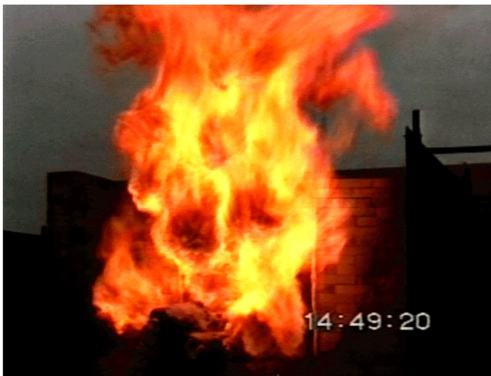
**Figure 7. FLAMES FROM 0.3 KG S<sup>-1</sup> PROPANE VAPOUR**
