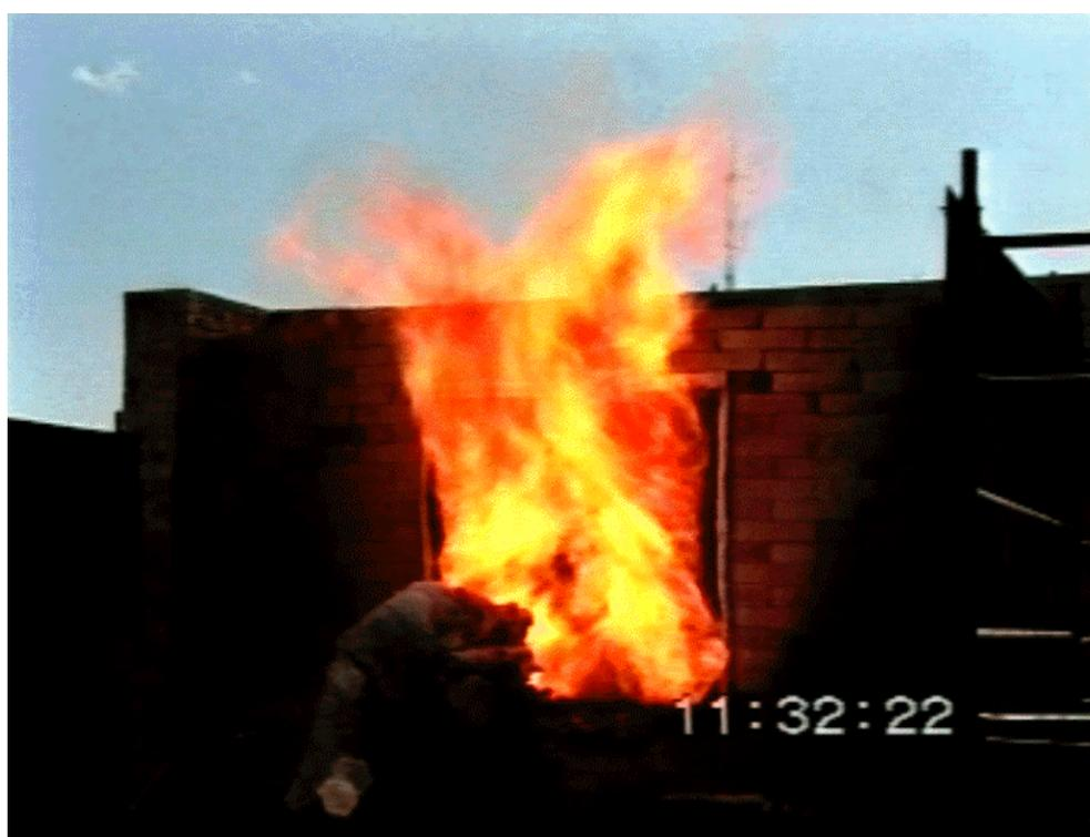
**Figure 8. FLAMES FROM 0.05 KG S<sup>-1</sup> PROPANE VAPOUR**
