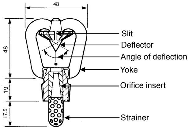
**Figure 1. MEDIUM VELOCITY NOZZLE**
