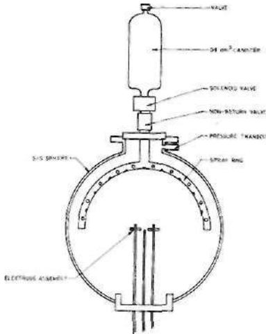
Figure 5 43 dm<sup>3</sup> spherical apparatus.
