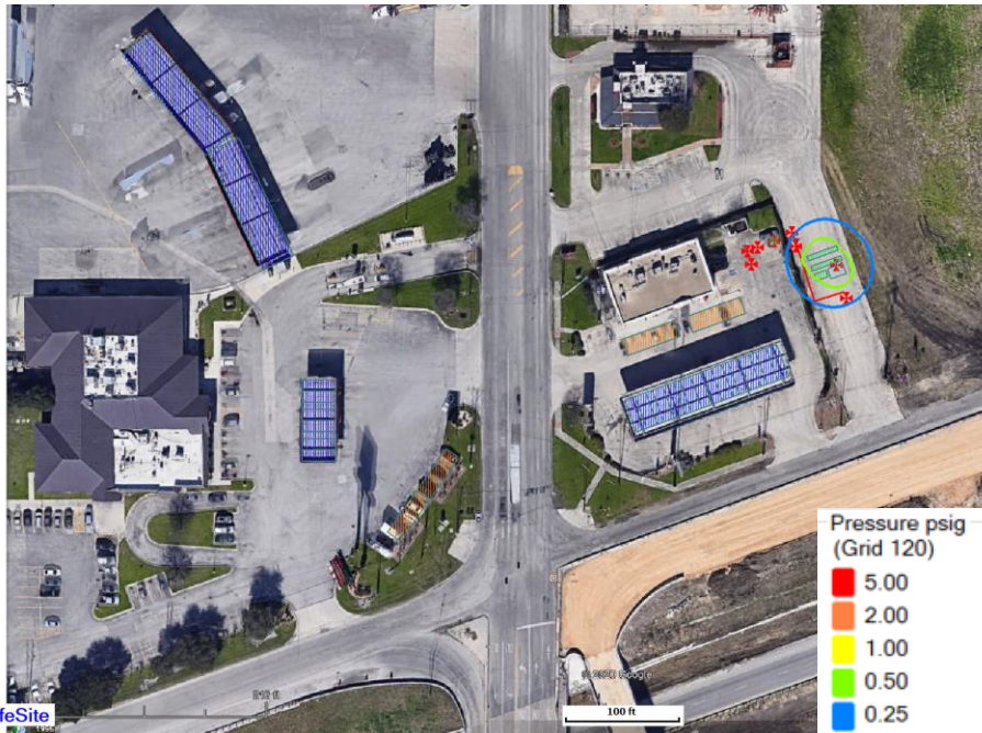
2-inch LNG Release (-260 F, 3 psig)
